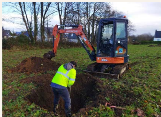
Test de type matsuo (source GEO 2 concept)
