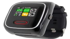
Ce dispositif est utilisé par un (ou plusieurs) agent(s) de crématorium « hors de vue et hors d'ouïe » d'autres agents. Il s'agit d'un appareil permettant d'alerter les secours en cas de problème. L'appel peut être déclenché de façon volontaire (accident) ou automatique, en cas de perte de verticalité du travailleur (malaise).
