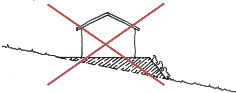
la mise à niveau par talutage
