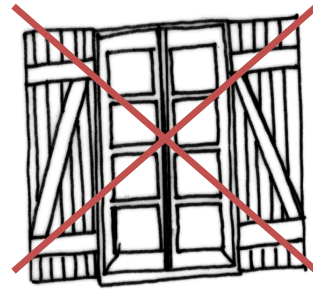
volets à écharpe dit « Z »
