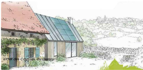
Implantation lors de la construction de l'annexe d'une maison rurale traditionnelle. Implantation faisant lire la rythmique de ses ouvertures (largeur de la baie vitrée).
