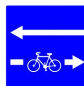
Panneau en entrée ou croisement de rue en double-sens cyclable. Ces panneaux sont recommandés sur des axes à 50 km/h ou des zones 30 à fort trafic (panneaux C24a et C24c)
