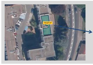
Sur la toiture de cette copropriété, il y a des nombreuses gaines. Il faut donc les contourner lors de la sélection de la surface. Cette toiture nécessite également de faire plusieurs mesures de surfaces, qui vont ensuite s'additionner.
